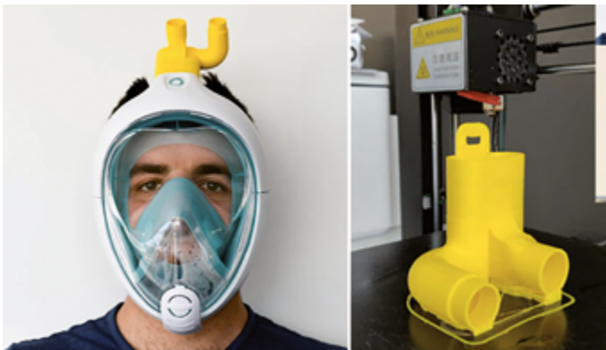
Masque de plongée transformé en respirateur (source : Isinnova)
